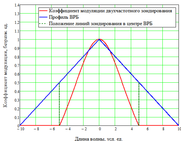
Рис. 3. Коэффициент амплитудной модуляции огибающей двухчастотного зондирующего излучения для В-ТРГ-ВБР при разносе частот: \varepsilon = 2.0
