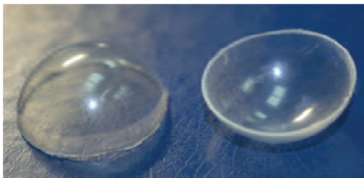
Модельные образцы полусфер мишеней для лазерного термоядерного синтеза
