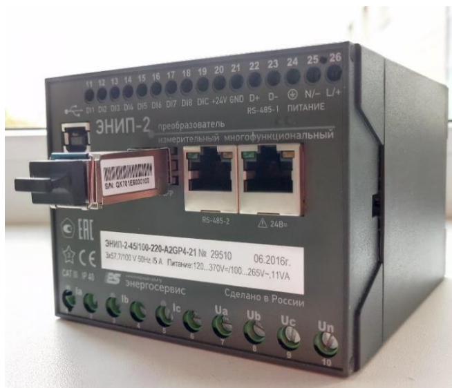
Рис. 11. Общий вид контроллера ЭНИП-2 с поддержкой технологии GPON со вставленным SFP GPON/EPON ONT модулем
