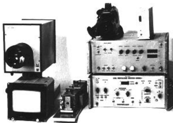
Рис. 1. Аппаратура комплекса технических средств «КАСКАД» для проведения внешнетраекторных измерений полета аэроупругих систем
