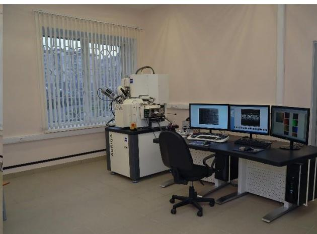
Сканирующий электронный микроскоп
