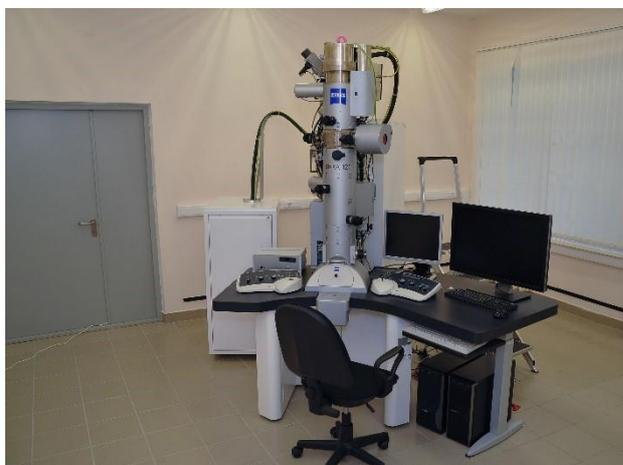
Просвечивающий электронный микроскоп
