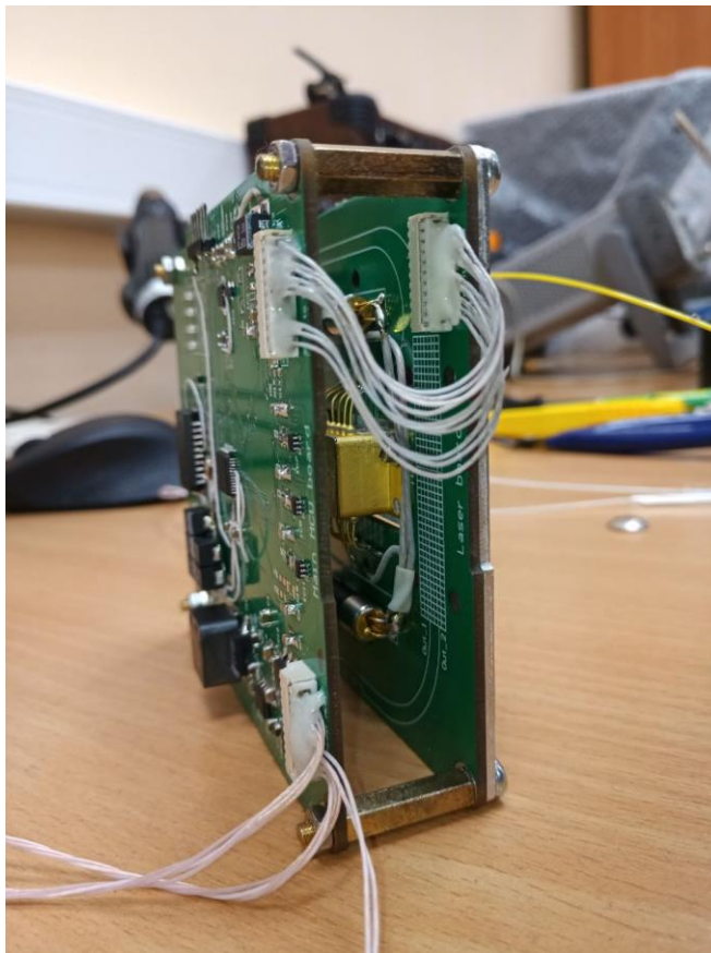
Рис. 2. Фото итоговой сборки встраиваемой системы определения температуры на борту микроспутника CubeSat (вид спереди)
