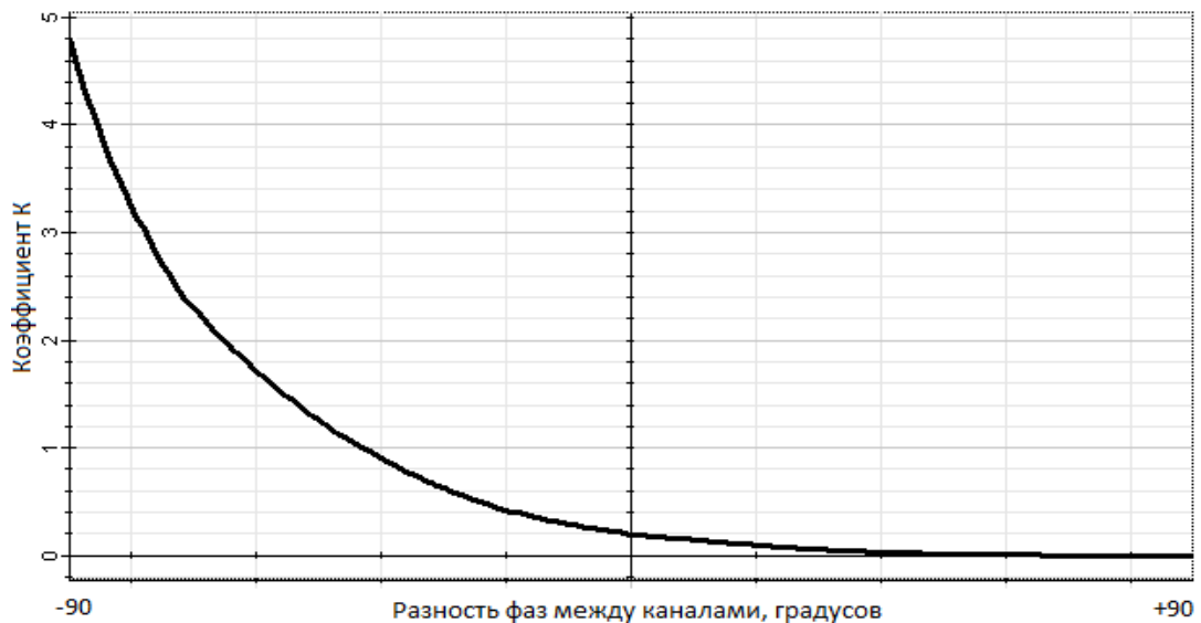
Рис. 2. Зависимость квадрата отношения мощностей сигналов на выходах фотодетекторов в каналах 1 и 2 K от сдвига фаз между сигналами на входах модуляторов
