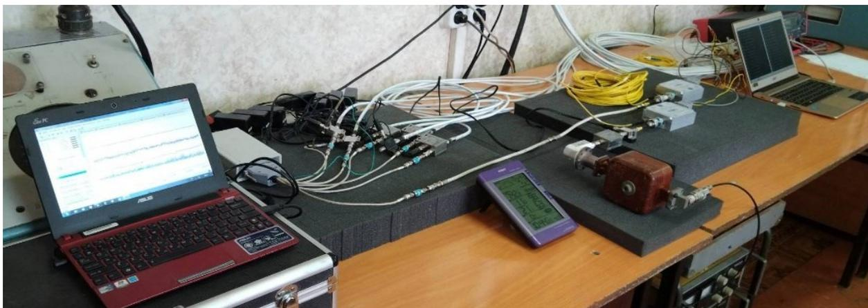
Рис. 3. Состав радиопотонного тракта передачи сигналов промежуточной частоты многочастотной микроволновой радиометрической системы
