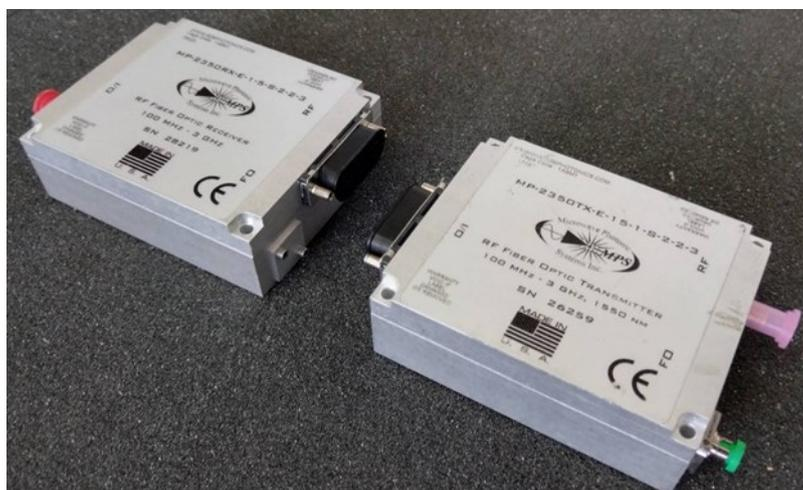
Рис. 4. Радиопотонные модули MP-2350-TX и MP-2350-RX
