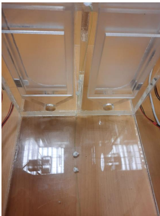
Рис. 6. Разводка волоконно-оптических датчиков на экспериментальной установке
