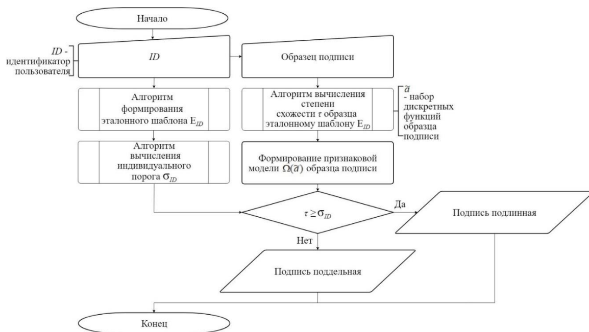
Рис.7. Блок-схема алгоритма распознавания
