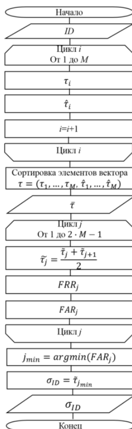
Рис. 6. Блок-схема алгоритма вычисления индивидуального порога
