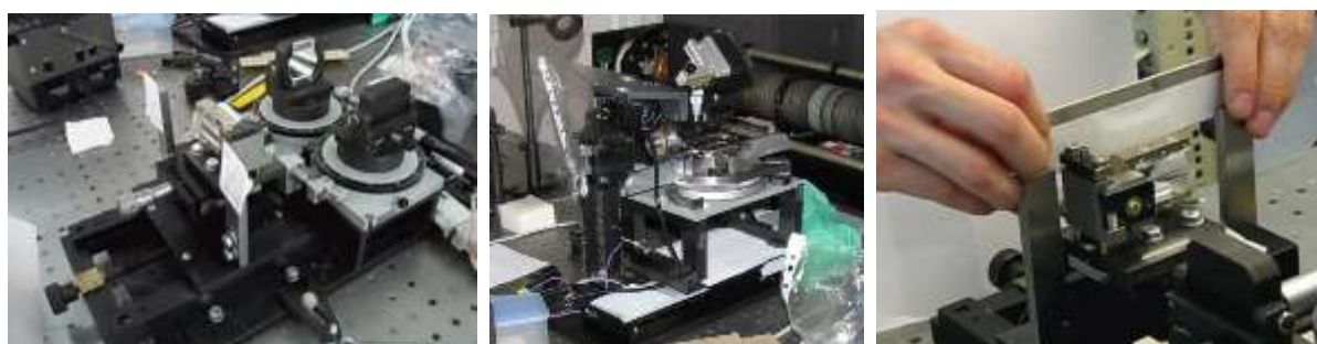
Рис. 11. Интерферометрические элементы для записи ВБР
