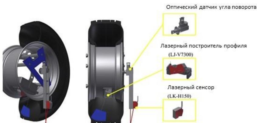
Рис. 1. Лазерная система измерения деформации шины [31]
