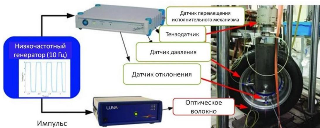
Рис. 3. Экспериментальная установка оценки статической вертикальной нагрузки на основе волоконно-оптических распределенных датчиках [34]
