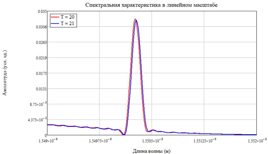
Рис. 10. Спектр отражения комбинированной структуры при температурном воздействии ( $T = 20$  °С — красная,  $T = 21$  °С — синяя линии)
