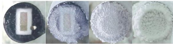
Рис. 6. Торец волокна, покрытый различными состояниями воды: лед, переходное состояние от инея, иней, снег (слева направо) [5]
