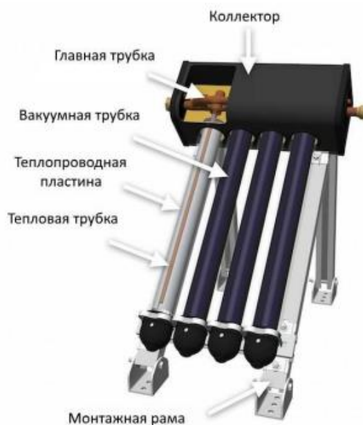
Рис. 2. Вакуумный солнечный коллектор с тепловыми трубками
