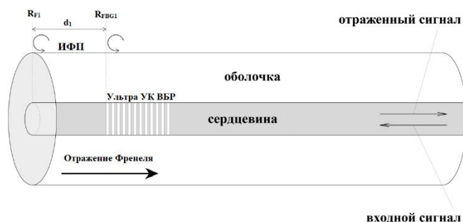
Рис. 1. Схема ИФП на основе сверхкороткой слабоотражающей ВБР и сколотого торца волокна
