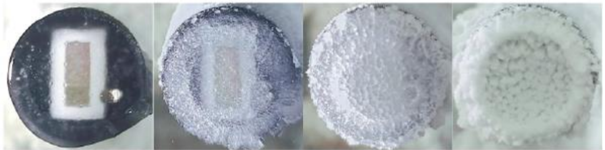
Рис. 3. Торец волокна, покрытый различными состояниями воды: лед, переходное состояние от инея, иней, снег (слева направо) [1]
