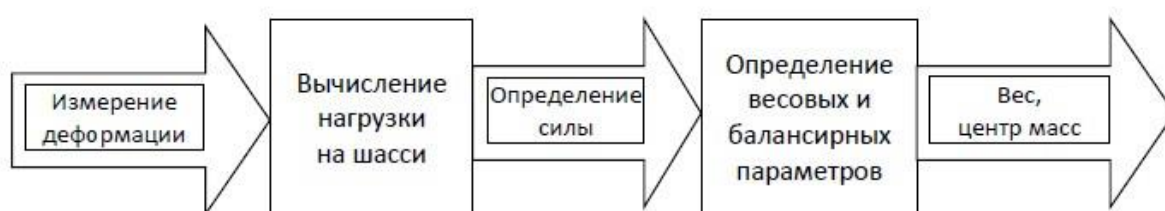
Рис. 1. Алгоритм работы системы контроля веса и балансировки
