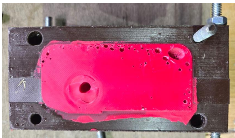
Рис. 2. Форма с застывшей восковой моделью ярко-красного цвета, частично извлечённая
