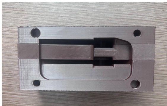
Рис. 1. Сборная FDM-форма из ABS после усиления конструкции
