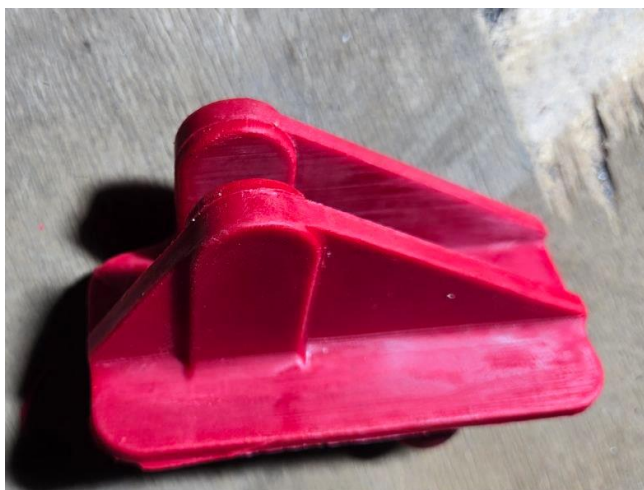
Рис. 3. Готовая восковая отливка, извлечённая из формы
