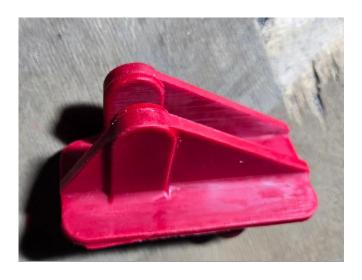
Рис. 3. Готовая восковая отливка, извлечённая из формы
