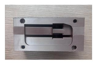
Рис. 1. Сборная FDM-форма из ABS после усиления конструкции
