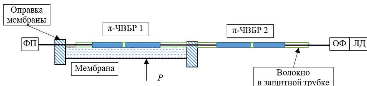
Рис. 1. Эскиз сенсорной части датчика гидростатического давления:
