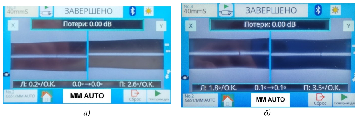
Рис. 4. Изображения сварных соединений на экране сварочного аппарата Fujikura-36S, выполненные в автоматическом режиме «ММ AUTO»: а) МСОВ – MMF «А»; б) МСОВ – MMF «Б»
