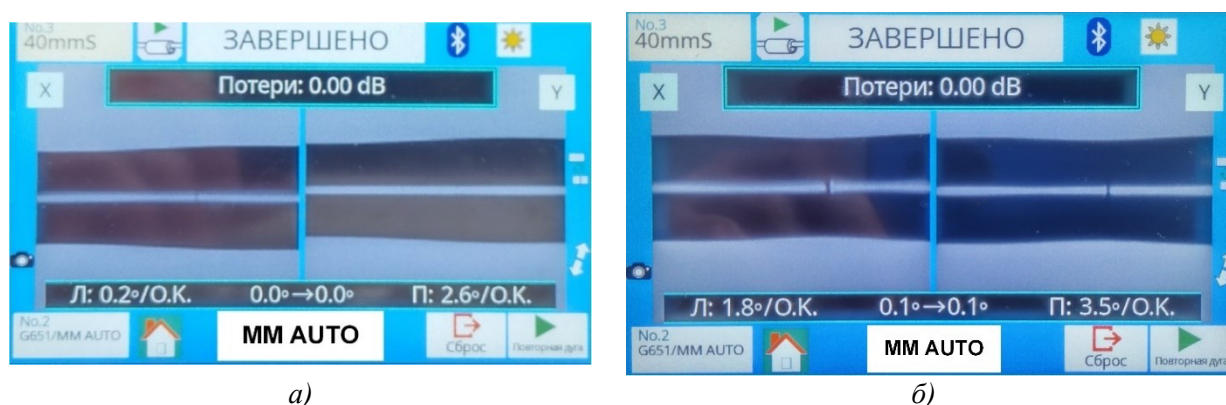
Рис. 4. Изображения сварных соединений на экране сварочного аппарата Fujikura-36S, выполненные в автоматическом режиме «ММ AUTO»: а) МСОВ – ММФ «А»; б) МСОВ – ММФ «Б»
