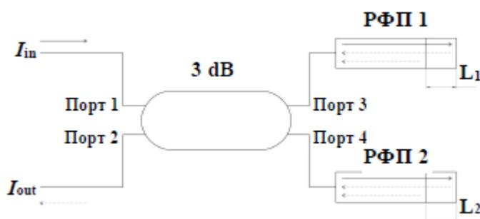
Рис. 1. Волоконно-оптический датчик на основе ИФП на основе параллельных РФП1 и РФП2
