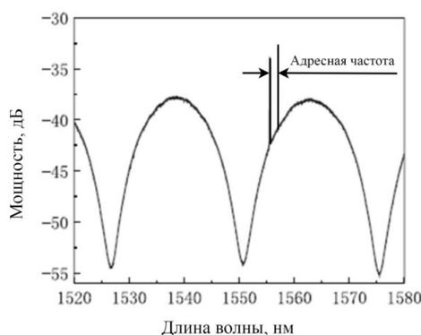
Рис. 1. Спектр отраженного излучения КВОД (лабораторные условия)
