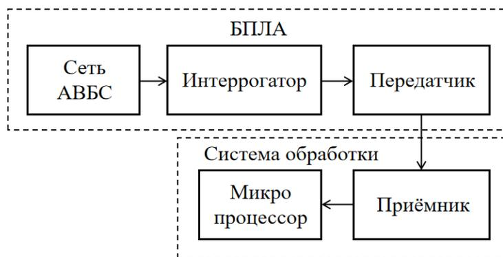
Рис. 1. Блок-схема системы СМР
