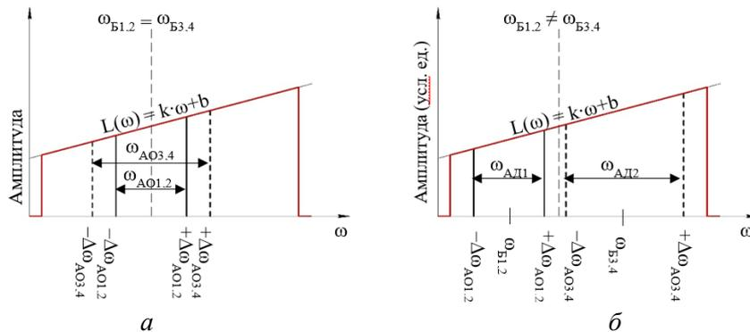
Рис. 1. Упрощенная спектральная характеристика отклика верхней и нижней АВБС после ОФНЛХ: невозмущенное состояние (а); при воздействии пациента (б)
