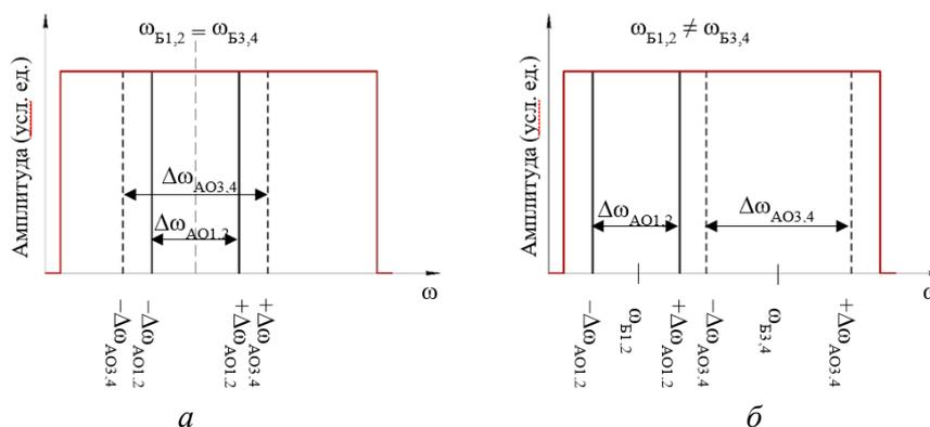
Рис. 1. Упрощенная спектральная характеристика отклика верхней и нижней АВБС: в невозмущенном состоянии (а) и при воздействии пациента (б)
